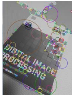
SIFT.py 各点が128次元の特徴ベクトルを持つ
